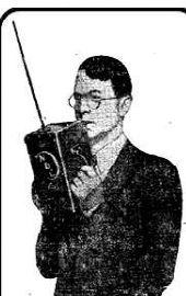
Инженер Национальной радиотелеграфной компании (США) с переносимым передатчиком типа «Камлет» (Camlet). С помощью такого передатчика диктор-оператор получает возможность производить передачу с любого места, на ходу.
